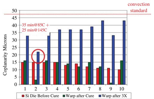
Fig. 15. Silicon warpage for Epoxy B.
